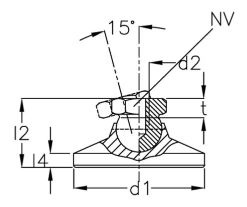
d1 = 25 d2 = 8 l2 = l4 = -NV = 12 Static load (kN) = 14 t min = 9
